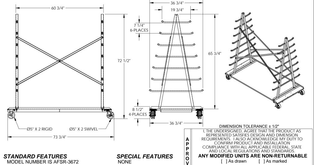
MODEL NUMBER IS AFSR-3672 OVERALL WIDTH IS 36 3/4" RACK WIDTH IS 36 3/4" OVERALL LENGTH IS 73 3/4" RACK LENGTH IS 60 3/4" OVERALL HEIGHT IS 72 1/2" RACK HEIGHT IS 65 3/4" MAX CAPACITY IS 2,000 LBS. Ø5" X 2" POLY-ON-STEEL CASTERS
