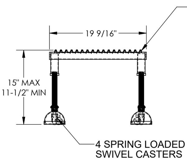
SERRATED STEEL PLATFORM FOR TRACTION
