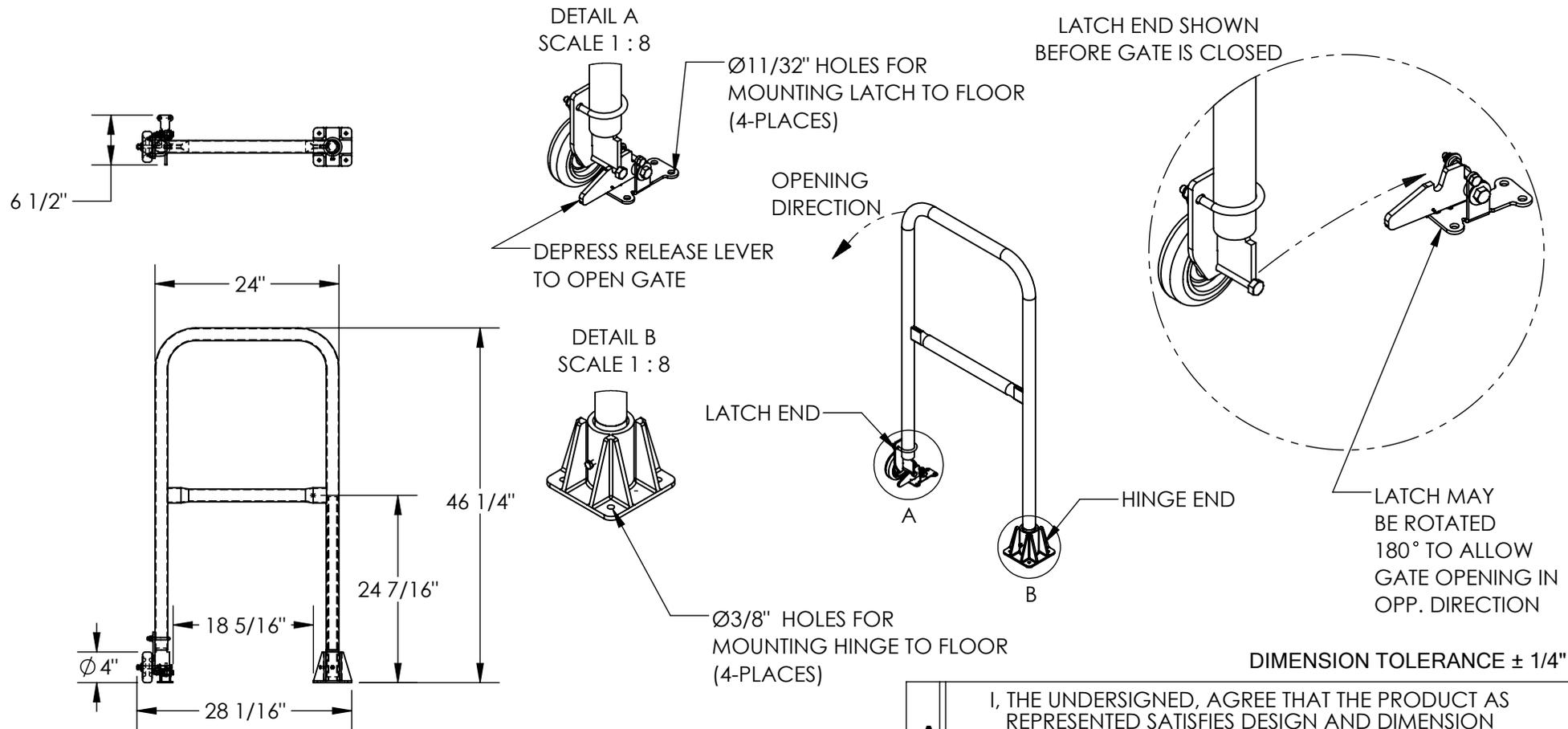
GATE OPENS IN JUST ONE DIRECTION. LATCH CAN BE POSITIONED TO ALLOW OPENING EITHER WAY. HINGE END CAN BE LOCATED ON RIGHT OR LEFT SIDE.
