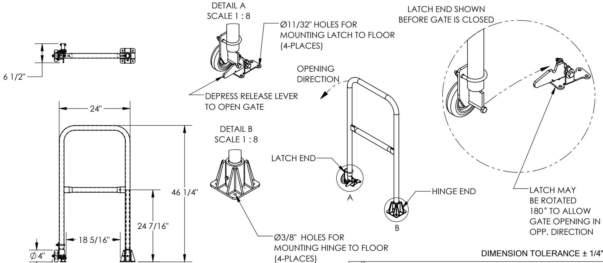
GATE OPENS IN JUST ONE DIRECTION. LATCH CAN BE POSITIONED TO ALLOW OPENING EITHER WAY. HINGE END CAN BE LOCATED ON RIGHT OR LEFT SIDE.
