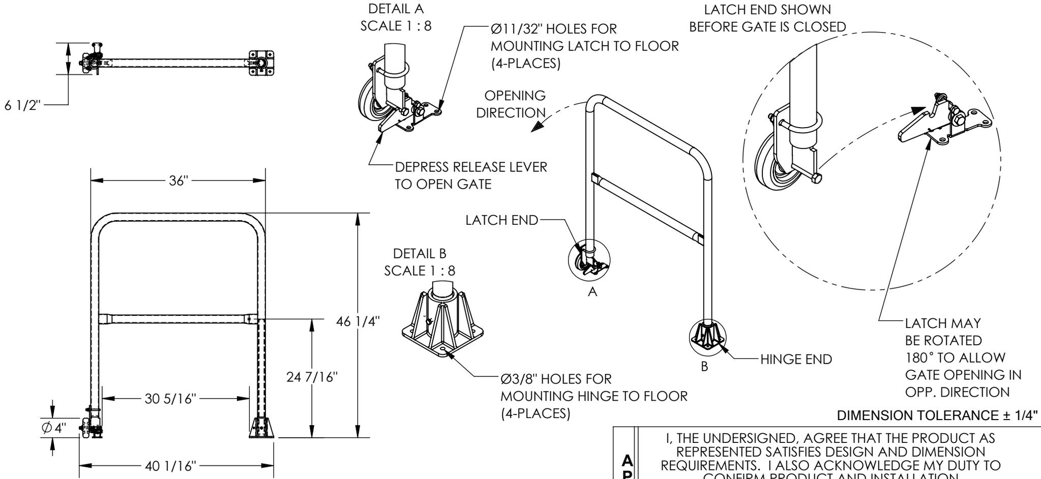
GATE OPENS IN JUST ONE DIRECTION. LATCH CAN BE POSITIONED TO ALLOW OPENING EITHER WAY. HINGE END CAN BE LOCATED ON RIGHT OR LEFT SIDE.
