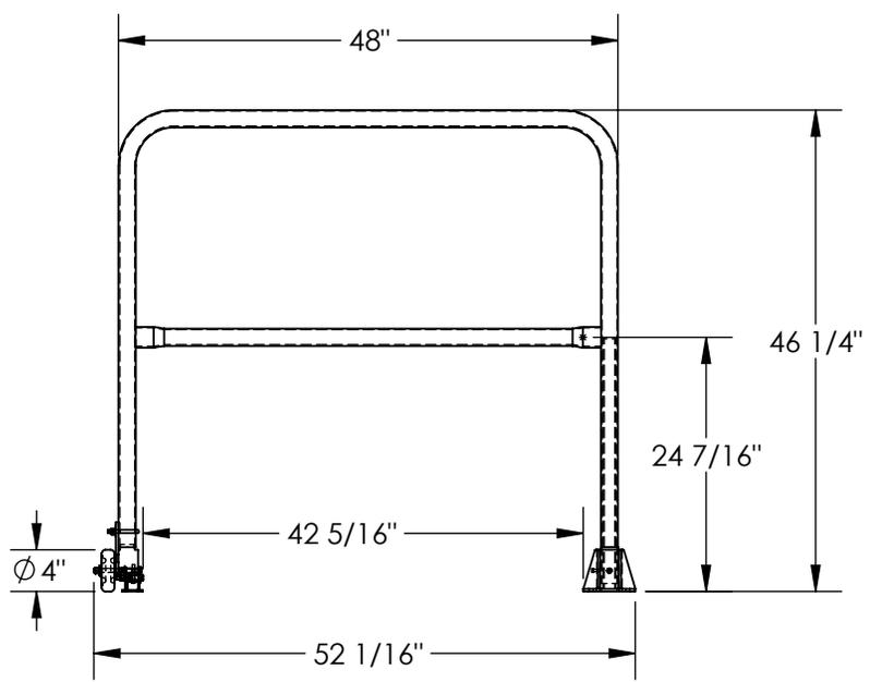
GATE OPENS IN JUST ONE DIRECTION. LATCH CAN BE POSITIONED TO ALLOW OPENING EITHER WAY. HINGE END CAN BE LOCATED ON RIGHT OR LEFT SIDE.
