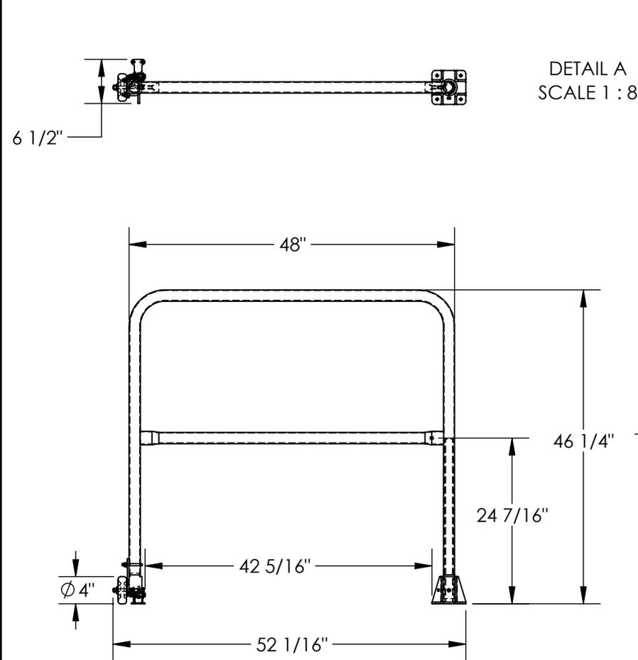
GATE OPENS IN JUST ONE DIRECTION. LATCH CAN BE POSITIONED TO ALLOW OPENING EITHER WAY. HINGE END CAN BE LOCATED ON RIGHT OR LEFT SIDE.
