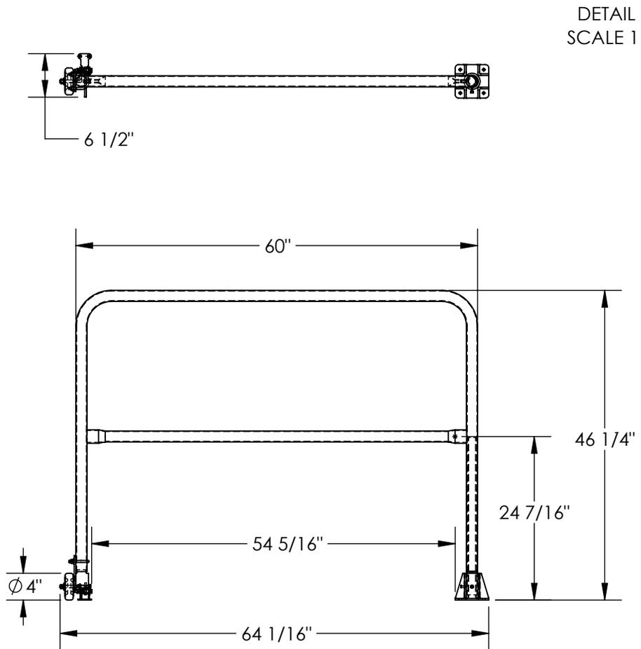
GATE OPENS IN JUST ONE DIRECTION. LATCH CAN BE POSITIONED TO ALLOW OPENING EITHER WAY. HINGE END CAN BE LOCATED ON RIGHT OR LEFT SIDE.
