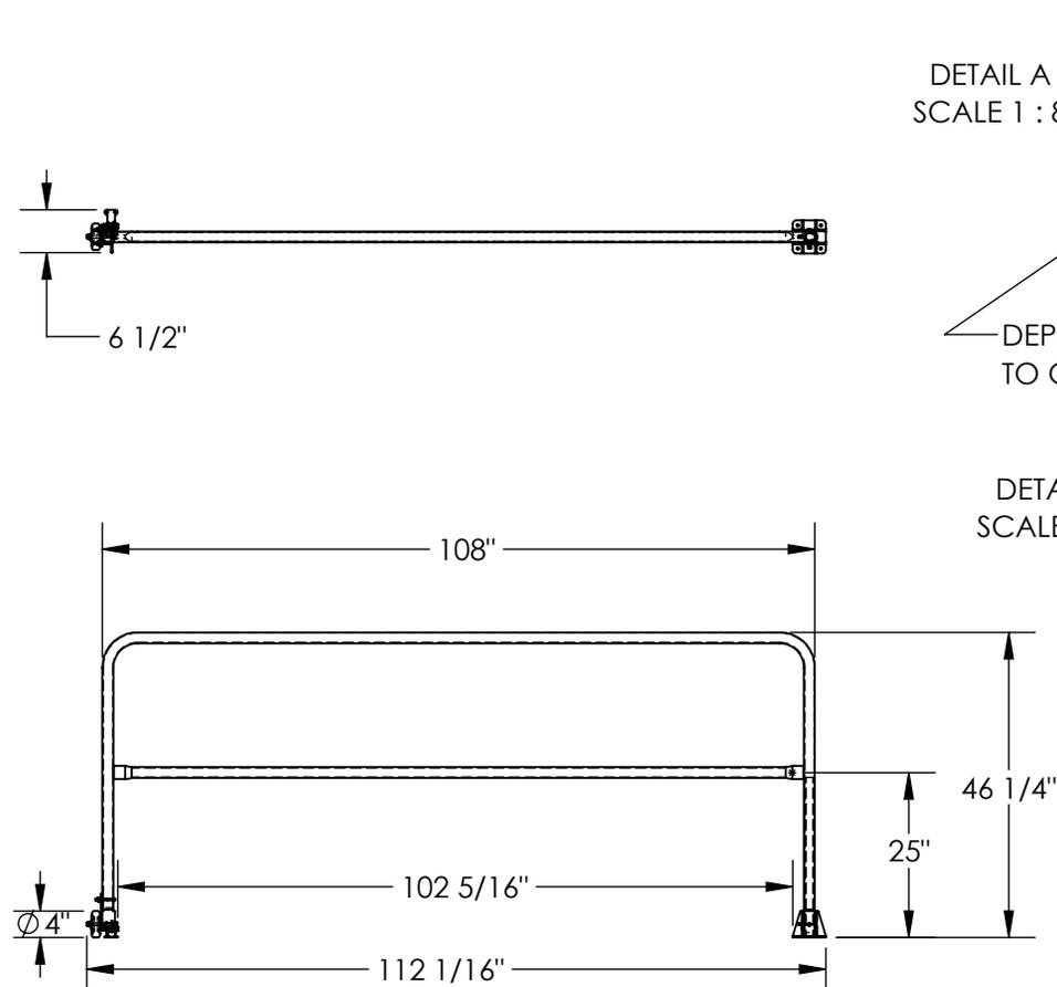
GATE OPENS IN JUST ONE DIRECTION. LATCH CAN BE POSITIONED TO ALLOW OPENING EITHER WAY. HINGE END CAN BE LOCATED ON RIGHT OR LEFT SIDE.
