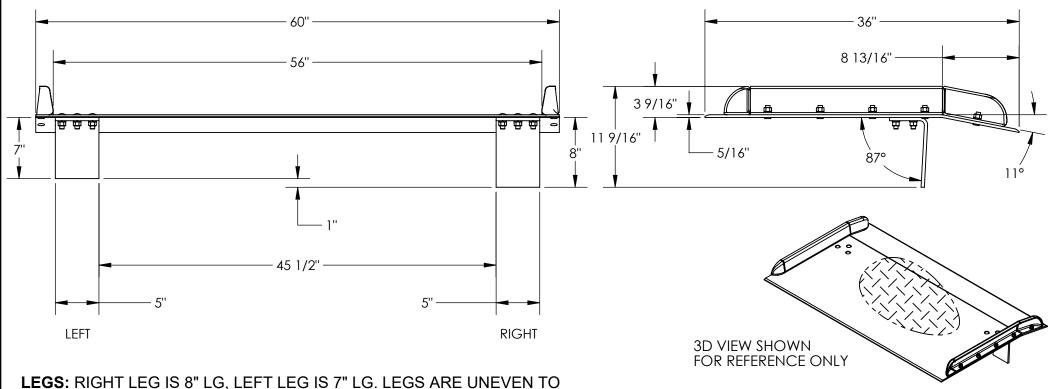
CREATE A GAP SO DOCKBOARD CAN BE PICKED UP BY A FORK LIFT
