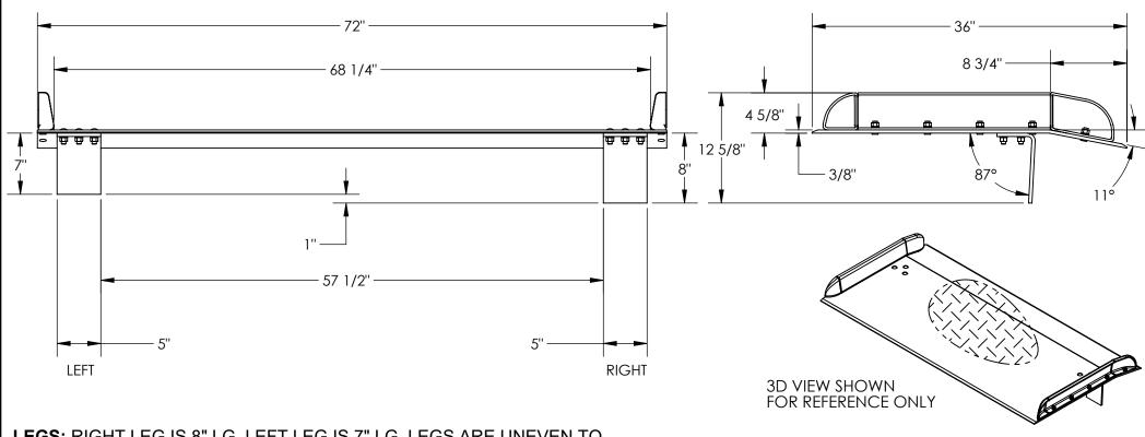
LEGS: RIGHT LEG IS 8" LG. LEFT LEG IS 7" LG. LEGS ARE UNEVEN TO CREATE A GAP SO DOCKBOARD CAN BE PICKED UP BY A FORK LIFT
