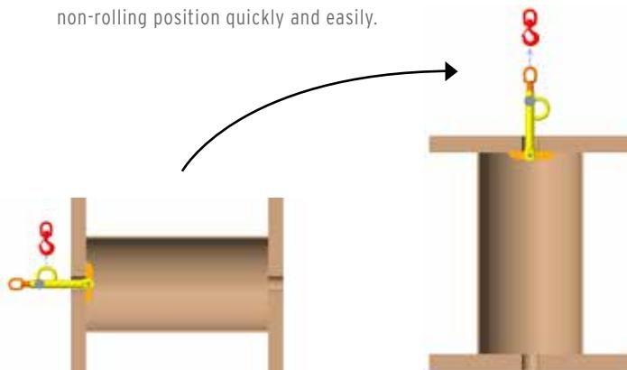
**\* TIP UP REEL FROM A ROLLING POSITION TO AN UPRIGHT POSITION, PAY OUT REEL IN UPRIGHT POSITION**
